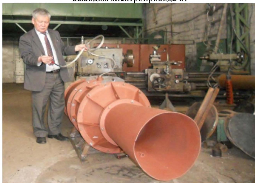
Фото 6. Общий вид осевого гидроэлектрического агрегата (ГЭА). Разработчик конструкции Т. Жумаев оценивает качество электрического провода.
