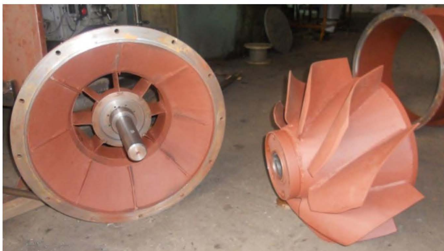
Фото 4. Виды на изготовленный корпус упора с осью (слева), куда будут установлено колесо турбинное (вид справа) через не вращающейся втулкой, расположенной внутри вращающейся на подшипниках качения ступицы
