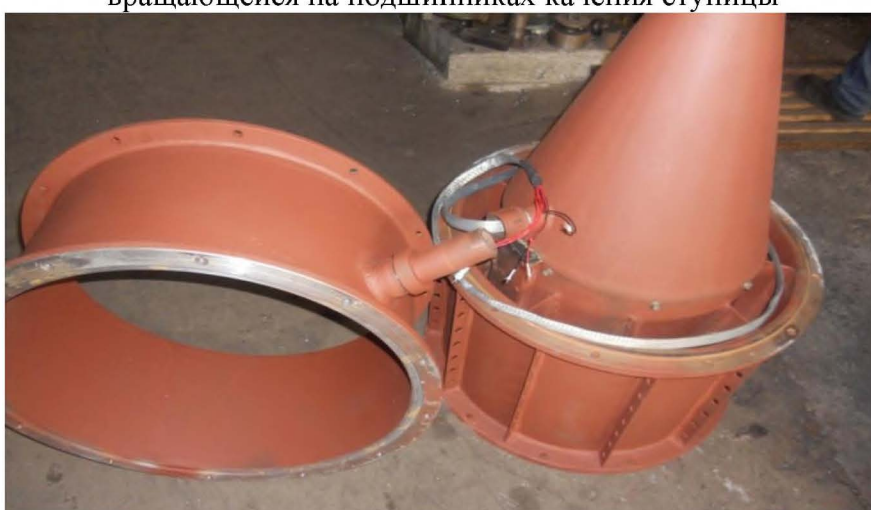
Фото 5. Вид на цилиндр – часть камеры приема потока рабочей воды, с насадкой для вывода электропровода от генератора (слева); корпус направляющего аппарата, на его лопастях подвешен с конусообразной задней крышкой кожух, где во внутрь вложен генератор с выводом электропровода от
