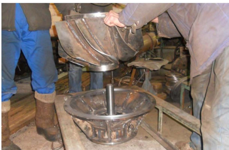
Фото 2. Процесс предварительной сборки колеса турбинного с его упором. Колесо турбинное устанавливается на ось упора введением во невращающую втулку внутри вращающейся на подшипниках качения ступицы
