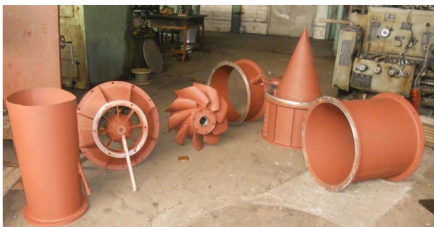
Фото 3. Изготовленные и грунтованные под покраску элементы осевого гидроэлектрического агрегата. Слева направо: отсасывающая труба; упор с корпусом для колеса турбинного; колесо турбинное; цилиндр – часть камеры приема потока рабочей воды, с насадкой для вывода электропровода генератора; корпус направляющего аппарата, на его лопастях подвешен с конусообразной задней крышкой кожух, во внутрь последнего вложен генератор; цилиндр – продолжение камеры приема потока рабочей воды
