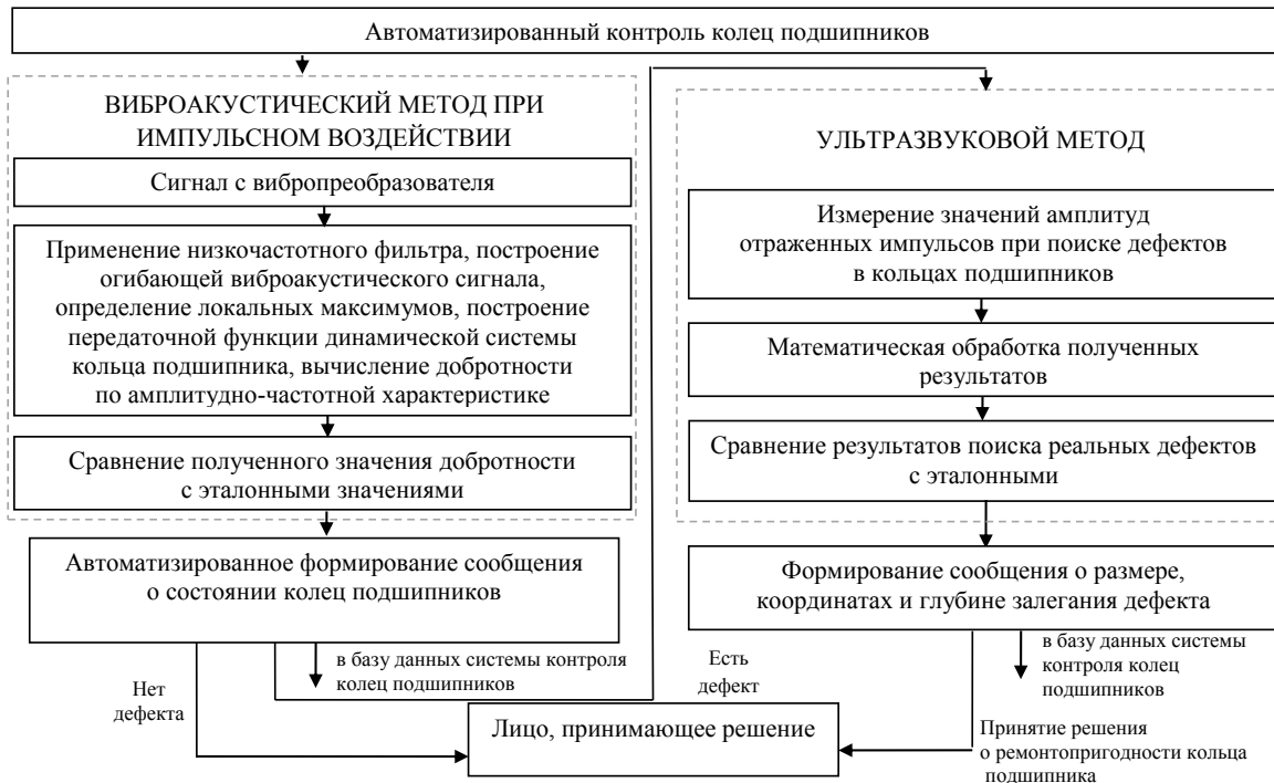
Рисунок 1 – Блок-схема комплексного автоматизированного контроля состояния колец подшипников
