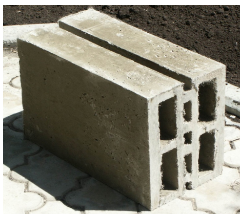
Фото 3 – Блоки из безавтоклавного ФПБ со средней плотностью 400 кг/м 3
