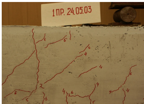
Фото 4 – Испытания перемычек из фибропеножелезобетона
