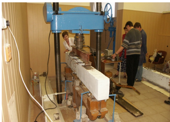
Фото 4 – Испытания перемычек из фибропеножелезобетона
