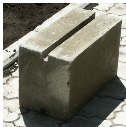
Фото 3 – Блоки из безавтоклавного ФПБ со средней плотностью 400 кг/м 3
