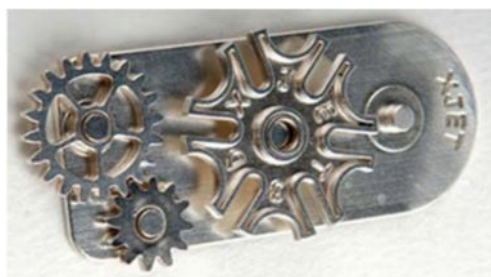
Рис. 8. Металлические изделия с мельчайшими деталями и идеально ровной поверхностью.
