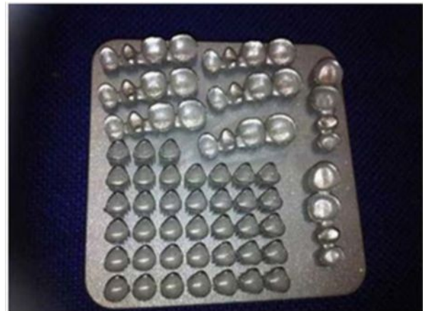
Рис.5. Частичные зубные протезы с использованием SLM.
