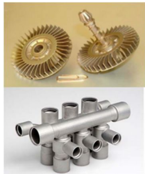
Рис.3. Сложные металлические детали распечатанные по технологии SLS.
