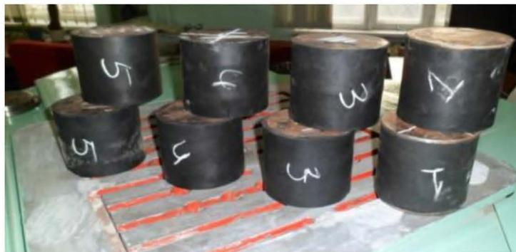
Рис. 2. Изготовленные резинометаллические опоры
