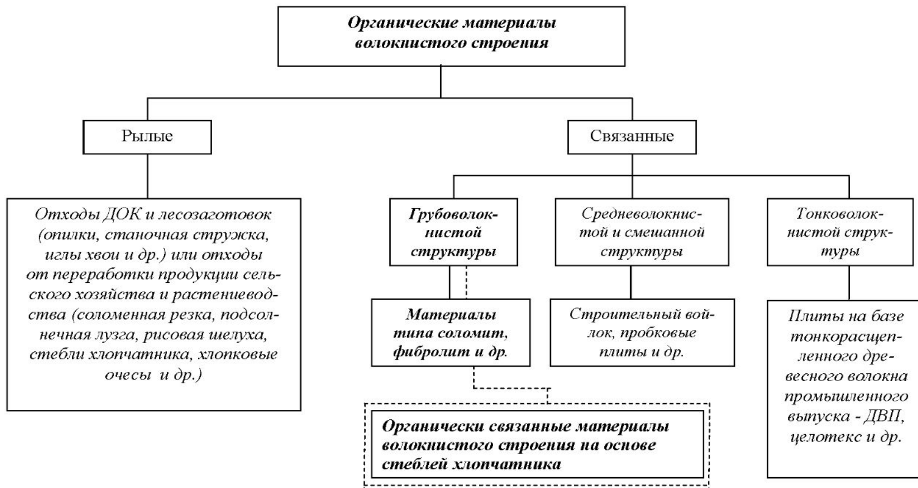
Рисунок 2.2 – Классификационная структура строительных материалов на основе отходов растительного сырья (классификации Б.Н. Кауфмана [24]).
