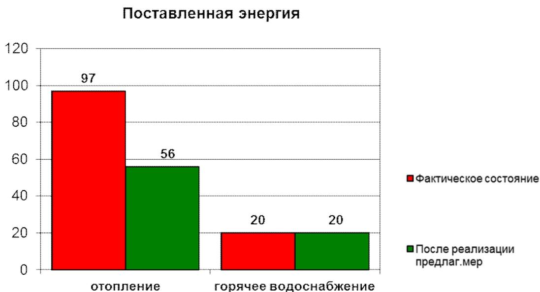
Рис. 3. Сравнение поставляемой энергии для существующего и прогнозируемого состояния здания
