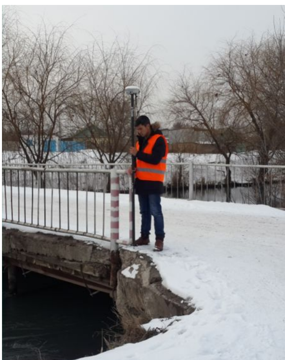
Рис. 2. Топографическая съемка в режиме RTK
