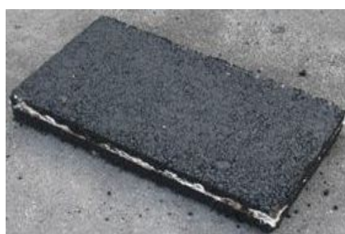
Рис.5. Плита армированного асфальтобетона после изготовления
