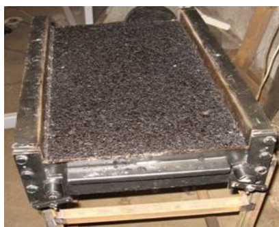
Рис.5. Плита армированного асфальтобетона после изготовления
