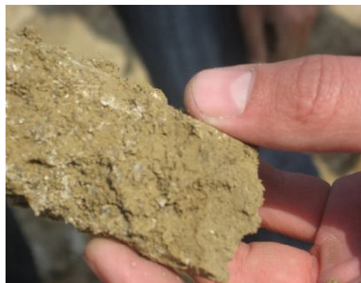
Рис. 2. Кристаллы соли в составе грунта
