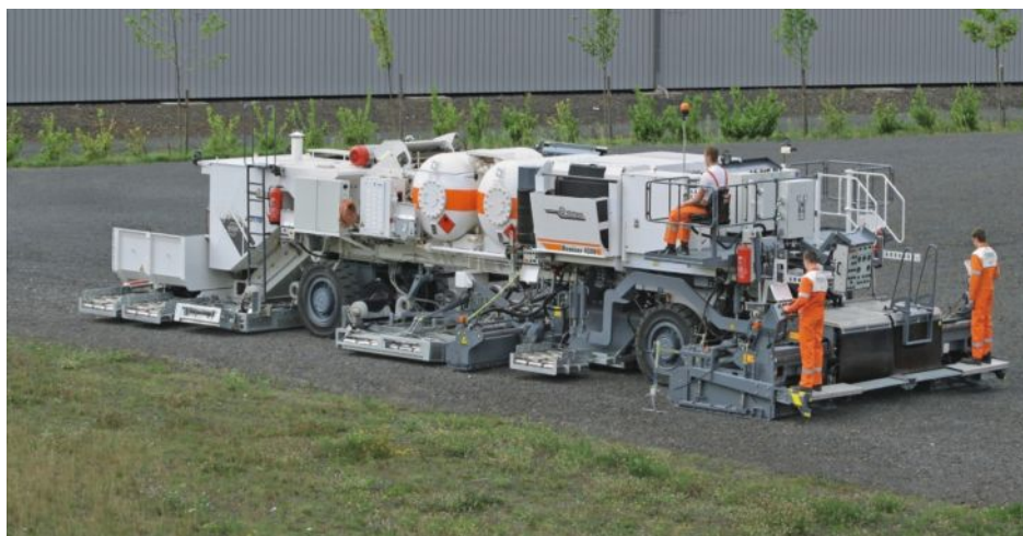
Рис.1. Агрегат для нагрева поверхности дороги, модель 4500 от фирмы WIRTGE (Германия)
