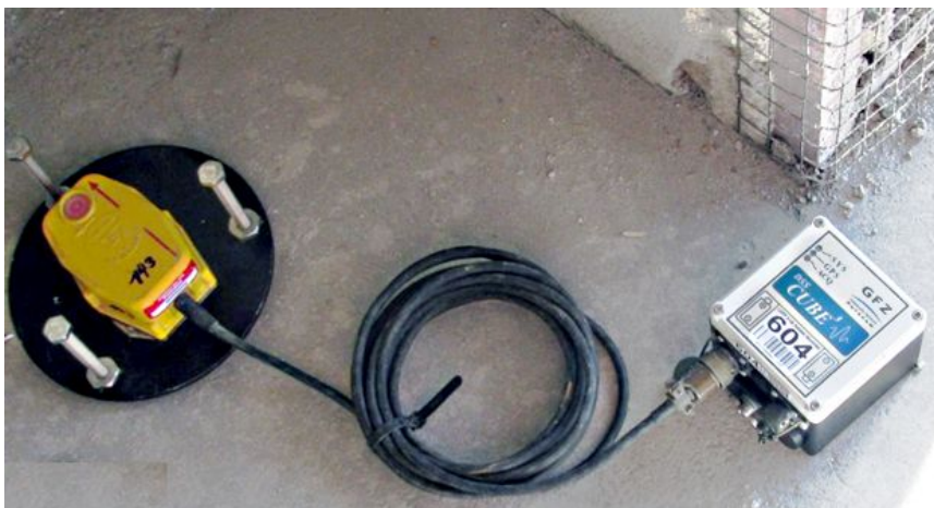
Рис.3. Пример использования сейсмостанции для регистрации микросейсмы: геофон 4,5 Гц (желтого цвета), 24-битное устройство записи (с надписью 604)
