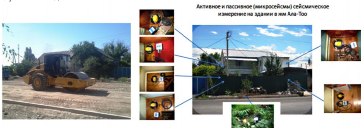
Рис.4. Наблюдение микросейсм в доме ж/м «Ала-Тоо» г.Бишкек: слева – воздействие на дом при работе дорожного виброролы LluGong CLG 616; справа - схема установки сейсмостанций и точки измерения микросейсм дома.
