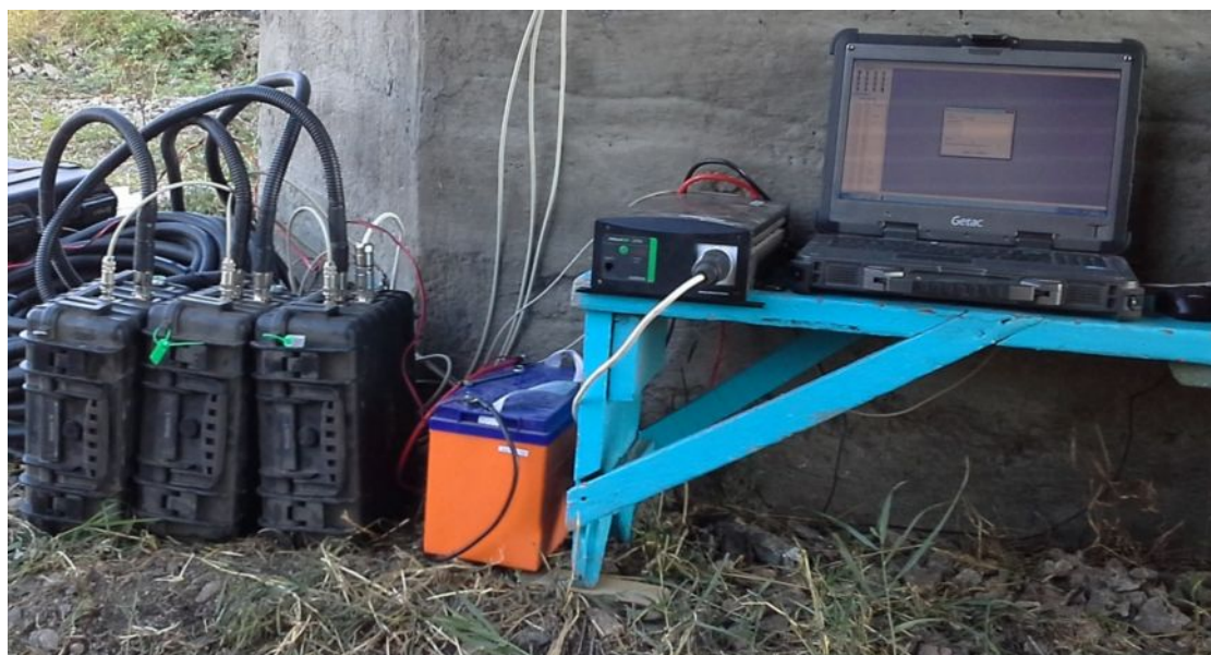
Рис. 3. Комплект оборудования для тензометрических измерений
