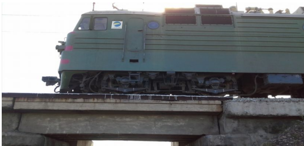
Рис. 4. Испытание конструкций пролётного строения под нагрузкой от осей 2-х секционного электровоза ВЛ-80 с , ось №8 на середине ребристой балки
