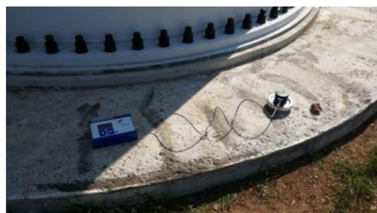
Рис. 5. Фиксирование вибродатчика на фундаменте ВЭУ
