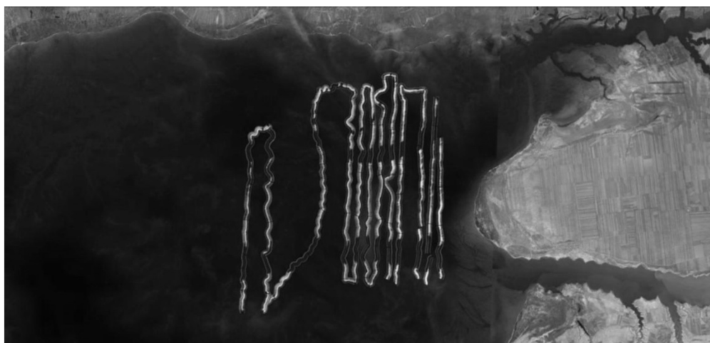
Рис.9. Визуализация гидролокационных изображений поверхности дна озера Иссык-Куль на полигоне «Сухой Хребет». Темными полосами обозначены древние береговые линии палеорусел рек Жергалан и Тюп.
