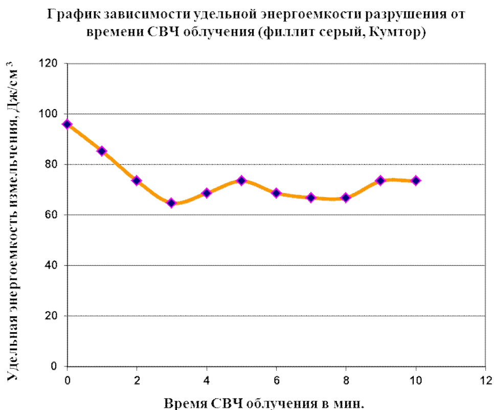
Рис.5. График изменения удельной энергоемкости измельчения темно-серого филлита (Кумтор) от продолжительности воздействия СВЧ волн.
