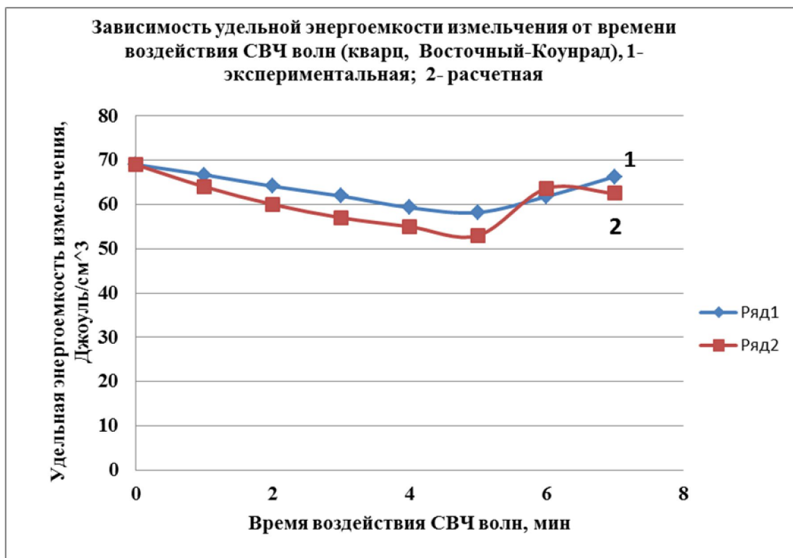
Рис. 5.3.4 - Графики экспериментального -1 и аналитического -2 определения удельной энергоёмкости измельчения кварца Восточно-Коунрадского месторождения.
