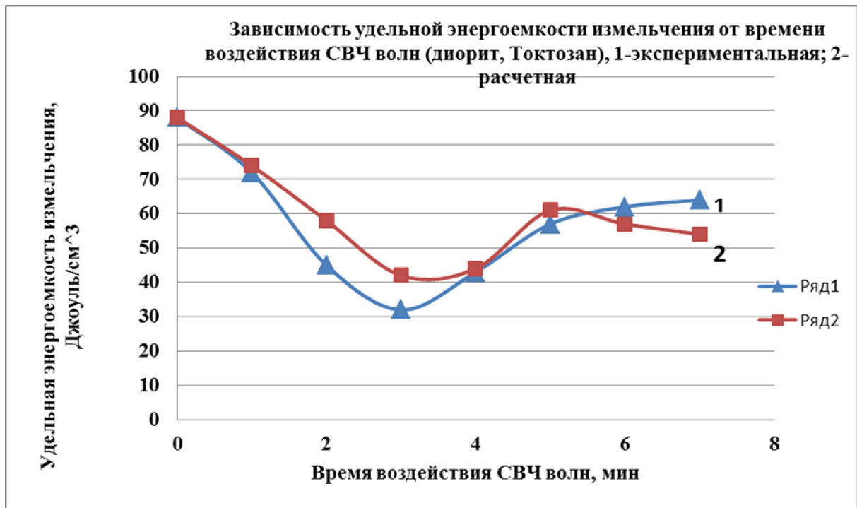
Рис. 5.3.2. Графики экспериментального -1 и аналитического -2 определения удельной энергоемкости измельчения диорита Токтозанского месторождения.
