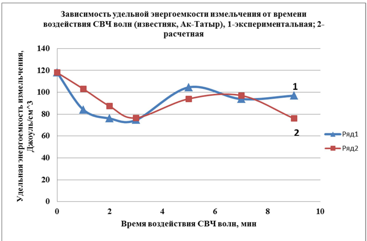
Рисунок 5.3.3 - Графики экспериментального -1 и аналитического -2 определения удельной энергоёмкости измельчения известняка Ак-Татырского месторождения.
