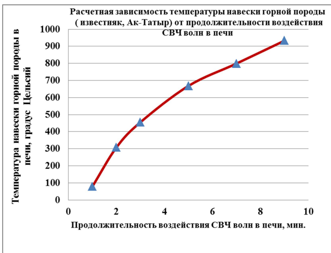
Рисунок 5.2.5 - График изменения температуры навески руды (известняк, Ак - Татыр) от продолжительности воздействия СВЧ волн.
