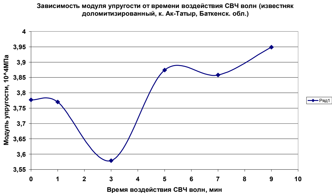
Рис. 5.1.6 . График изменения модуля упругости от продолжительности СВЧ воздействия (известняк доломитизированный, к. Ак-Татыр, Баткенская область) .
