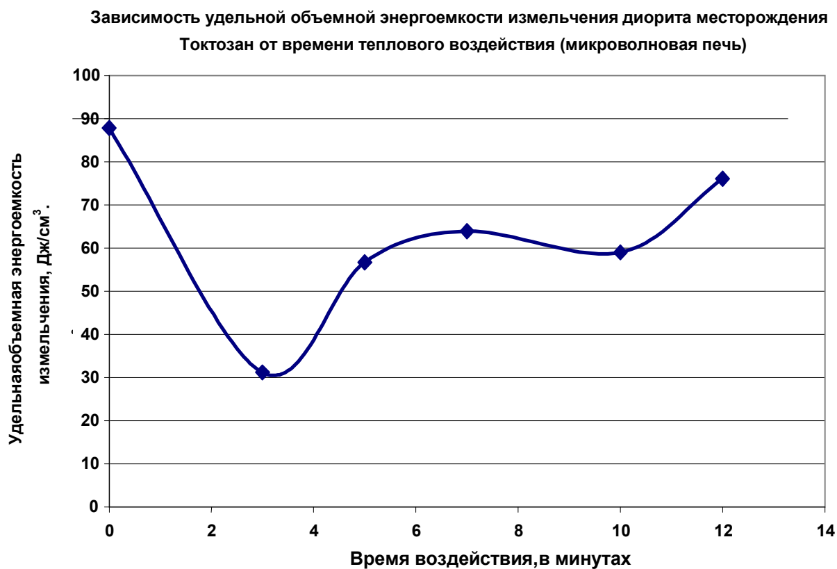
Рис. 5.4.2. График зависимости удельной энергоёмкости измельчения диорита от времени воздействия СВЧ волн.
