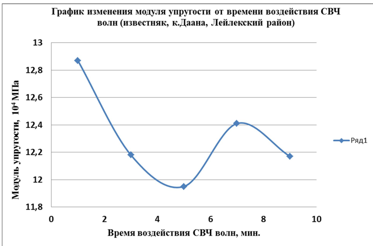
Рис. 5.1.7. График изменения модуля упругости от продолжительности СВЧ воздействия (известняк, к. Даана, Лейлекский район).
