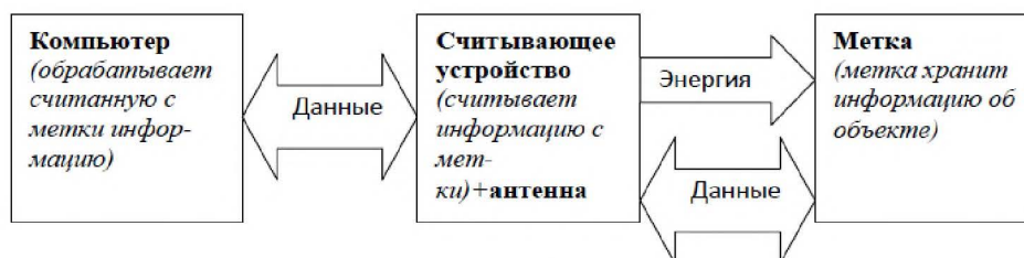
Рис. 1. Принцип работы RFID- системы
