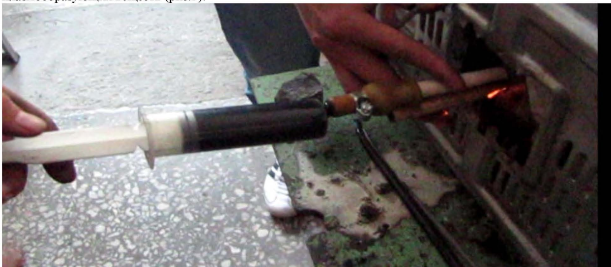
Рис.2. Подача нефти в керамическую трубу плазматрона.
