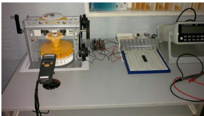
Рис.2. Фотоснимок макетного образца микроГЭС с дифференциальным приводом.
