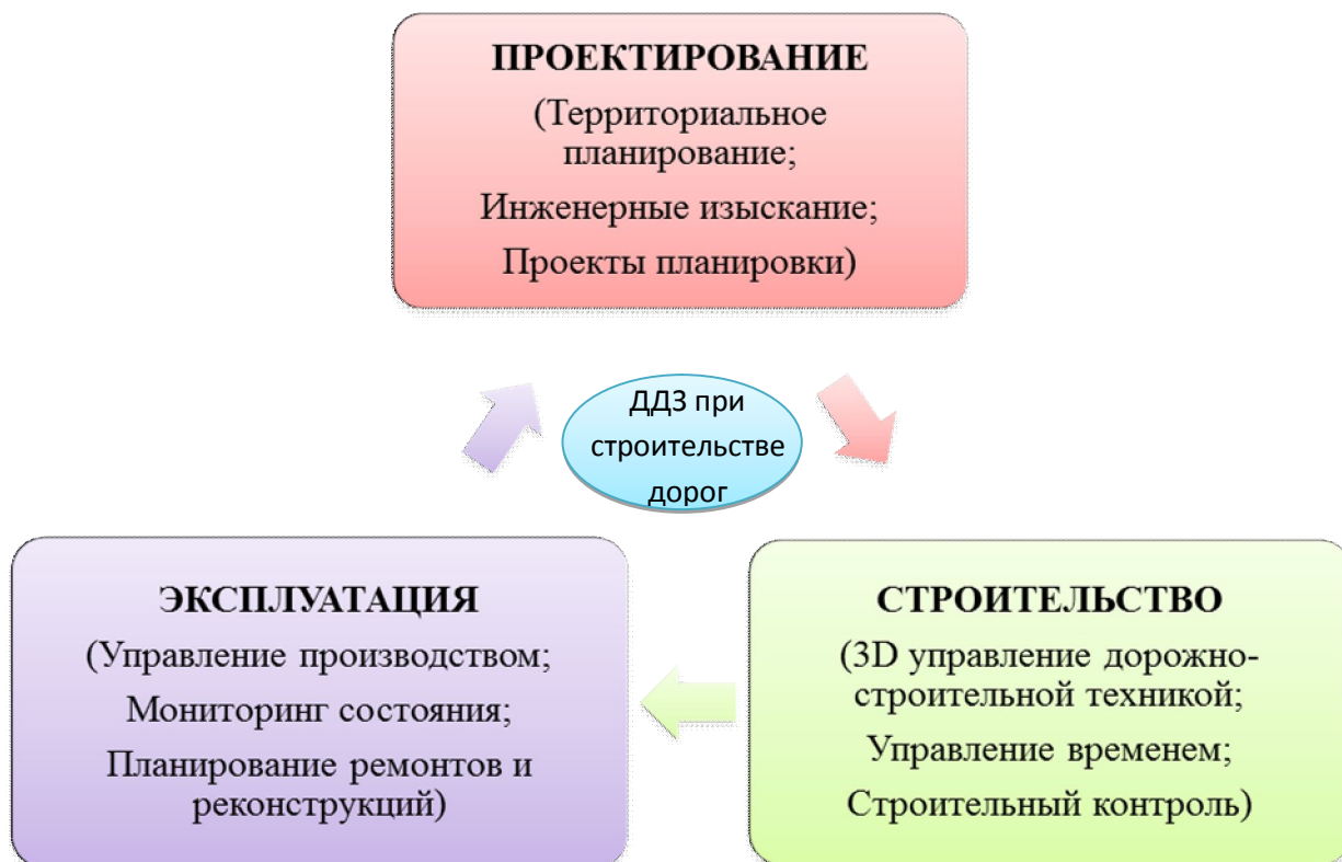
Рис. 3. Жизненный цикл строительства автомобильных дорог
