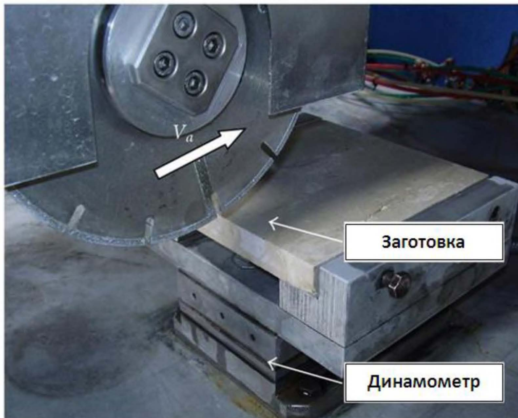
Рис. 1: Механическая обработка камня.
