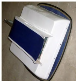
Рис. 1. Мобильный автономный робот, способный перемещаться по поверхностям с нулевым и отрицательным уклонами
