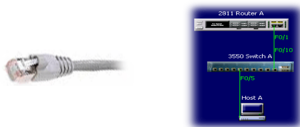
Рис. 9. Графическое представление связи между устройствами через кабель типа Straight-Through
