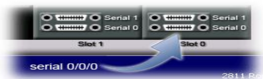
Рис. 13. Выбор интерфейса serial 0/0/0 на маршрутизаторе 2811 Router A
