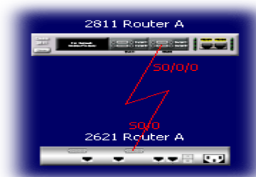
Рис. 11. Графическое представление связи между устройствами через кабель типа Serial WAN
