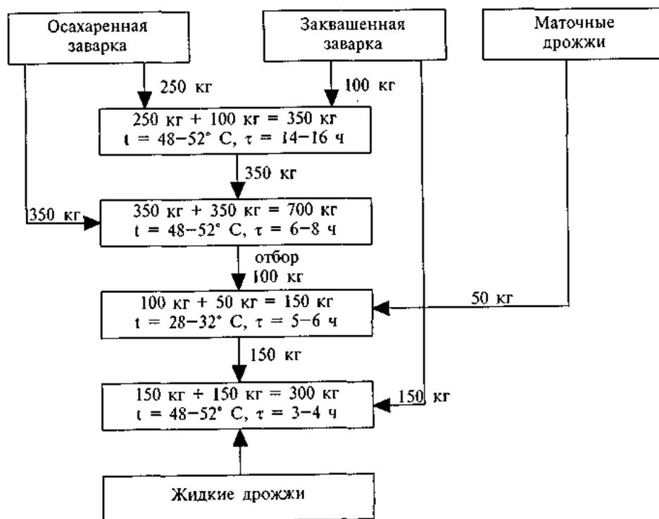
Рис. 10. Расход сырья и параметры процесса приготовления жидких дрожжей (I вариант)
