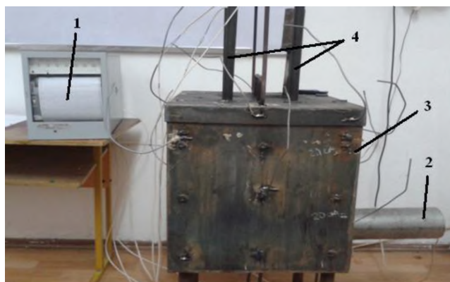
Рис.3. Бак-аккумулятор с прибором для измерения температуры
