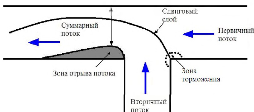
Рис. 1. Течение в канале с разветвлением 90^\circ .
