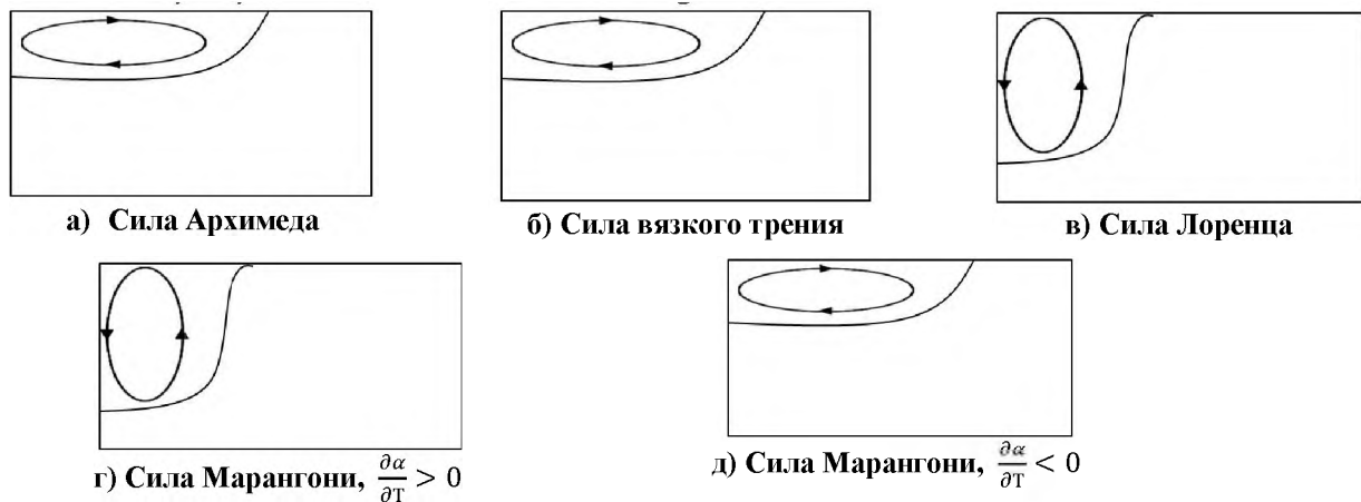
Рис.2 Направление потоков жидкого металла в сварочной ванне при воздействии различных сил
