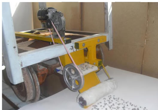
Рис. 2. Стенд устройства для распределения горячего песка на ледяную поверхность горной дороги, изготовленный на основе чертежей, выполненных на Solid Works
