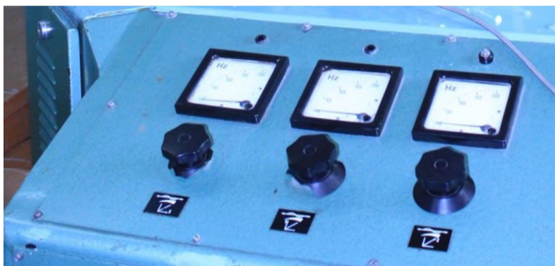
Рис. 9. Пульт управления вибростендом
