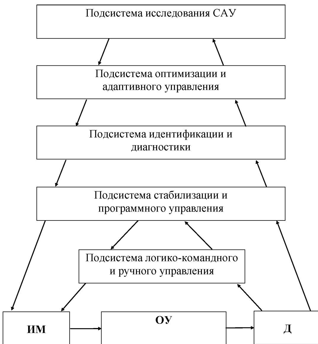
Рисунок 1.4.4. Функциональные подсистемы САУ.
