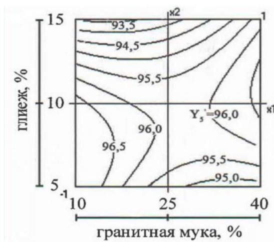
Рис.3.24.Изолинии тонкости помола композиционного вяжущего:
