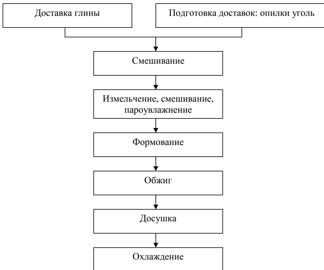
Рис. 3. Технологический процесс изготовления глиняного кирпича методом пластического формования
