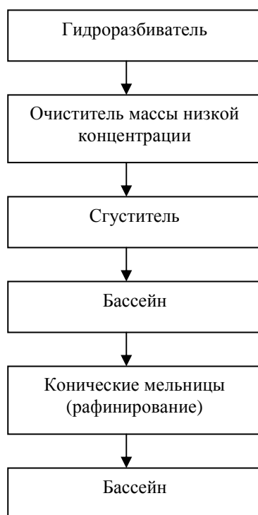
Рис. 3. Схема переработки макулатуры при низкой концентрации
