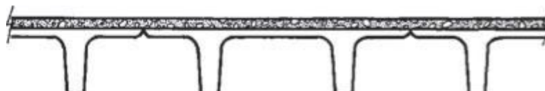
Рис. 1.34. Сборные железобетонные перекрытия из панелей типа ТТ
