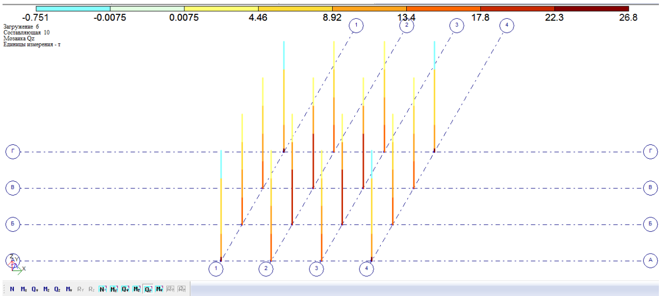
Рис. 3.37. Мозаика усилий " Q_z " в стойках при включении в схему гибких крестовых связей
