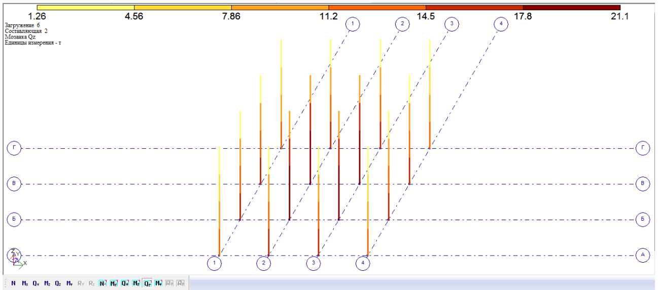
Рис. 3.36. Мозаика усилий " Q_z " в стойках исходной схемы
