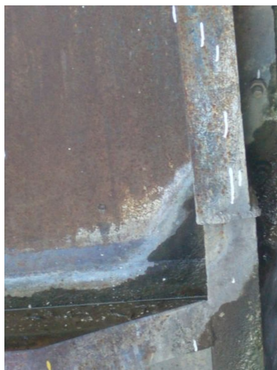
Рис. 4.9. Деформированная обшивка и оторванный сварочный стык правой опорной балки II сегментного затвора
