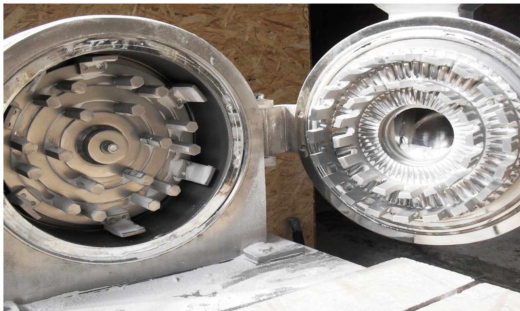
Рис. 1. Дисмембратор: 1- корпус; 2- ротор; 3-статор; 4- пальцы ротора; 5- пальцы статора; 6- сетка.
