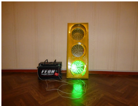
Рисунок 1 – Светофор, питаемый от автомобильной аккумуляторной батареи
