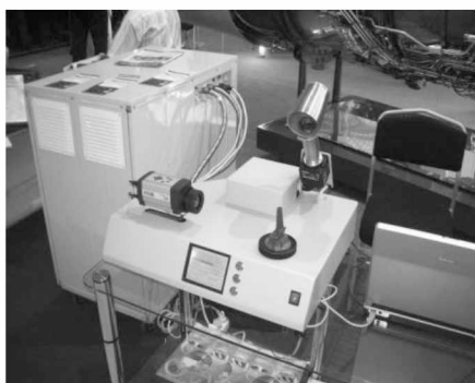
Рисунок.1. Автоматизированная установка для инфракрасной диагностики охлаждаемых лопаток турбин (АСТКЛ)
