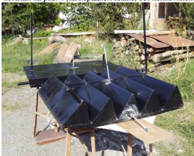
Рис. 7. Общий вид мобильной солнечной водонагревательной установки без полиэтиленовой пленки (на переднем плане).
