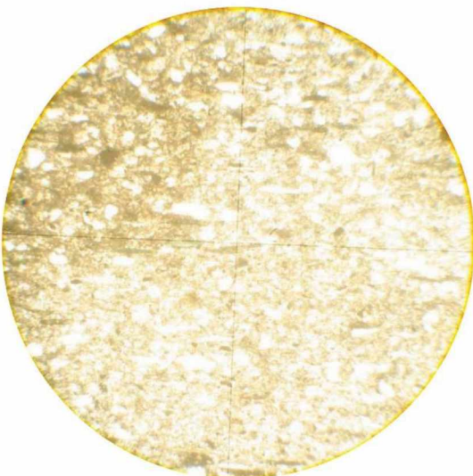
Фото 9. Трахит микрокристаллический. Уч. Бура, скв.3. Без анализатора. Ув. 135.
