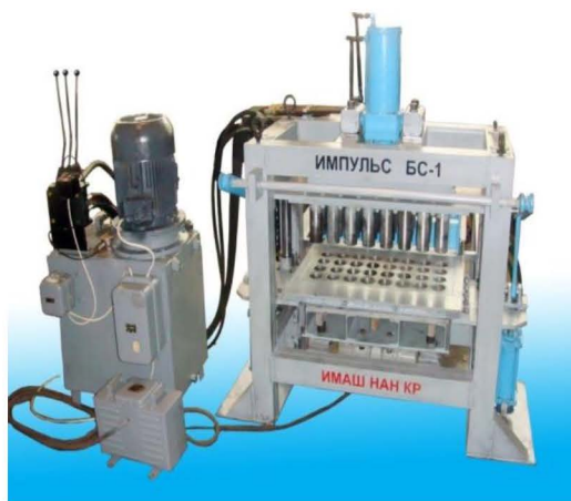
Рис. 7. Гидравлическое вибропрессовое оборудование для брикетирования угольной мелочи Импульс БС-1,0.
