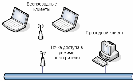
Рис. 1. Структура беспроводной сети с точкой доступа в режиме повторителя
