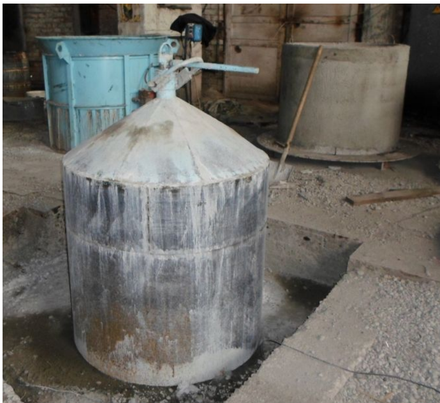
Рис. 1. Виброформа УКК для изготовления колодезного кольца
