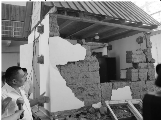
Рис. 1. Общий вид модели дома «сокмо» после эксперимента
