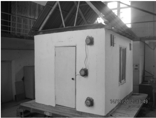
Рис.6. Общий вид модели дома из “железобетонного каркаса”, после эксперимента
