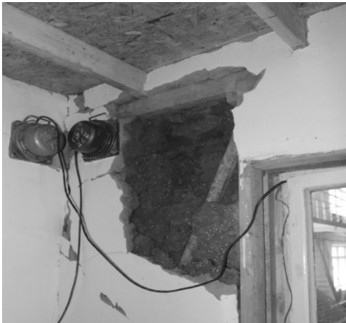
Рис.4. Общий вид модели дома типа “сынч”, после эксперимента
