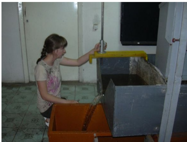
Рис.4.8. Измерение отводимых расходов воды.
