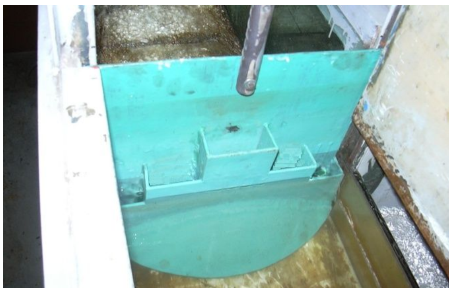
Рис.4.7. Модель СРВКК, установленная в ГЛЛ, при переливе в первую секцию стабилизатора.
