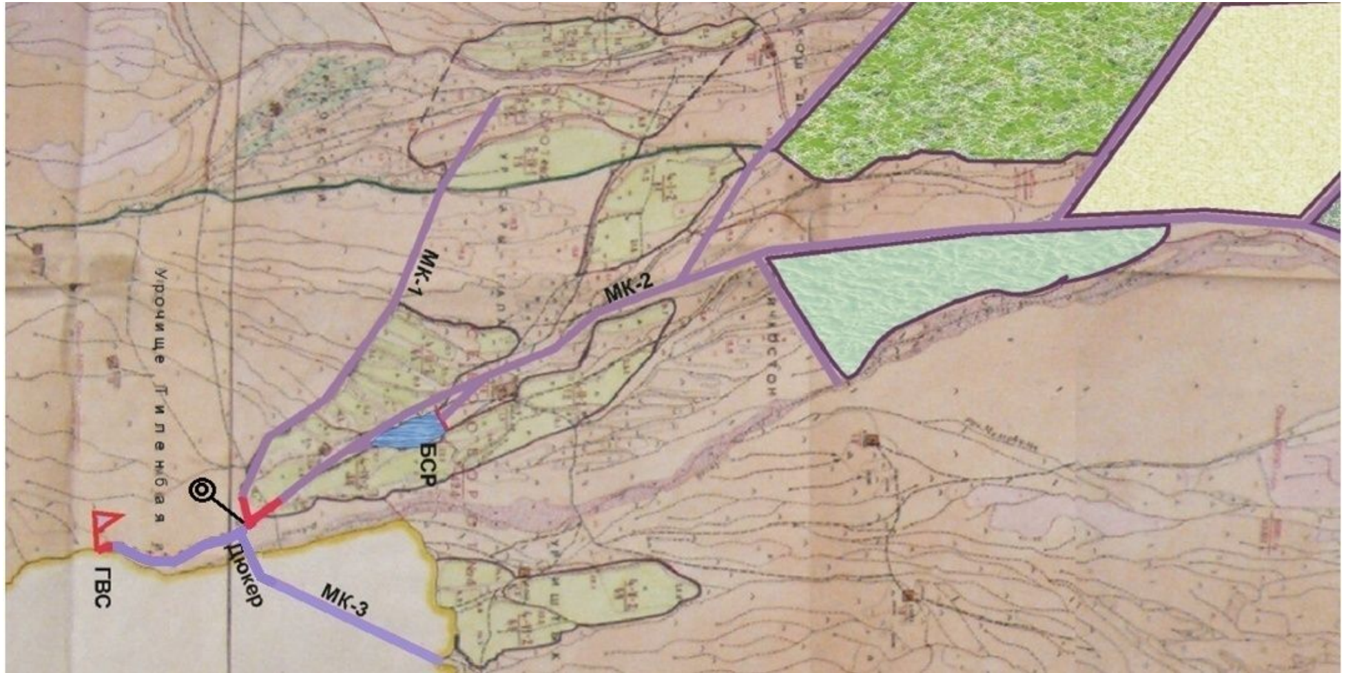
Рис. 5.1. Схема размещения водовыпускного сооружения на канале «Отводящий» системы р. Ак-Сай Ак-Талинского района Нарынской области.
