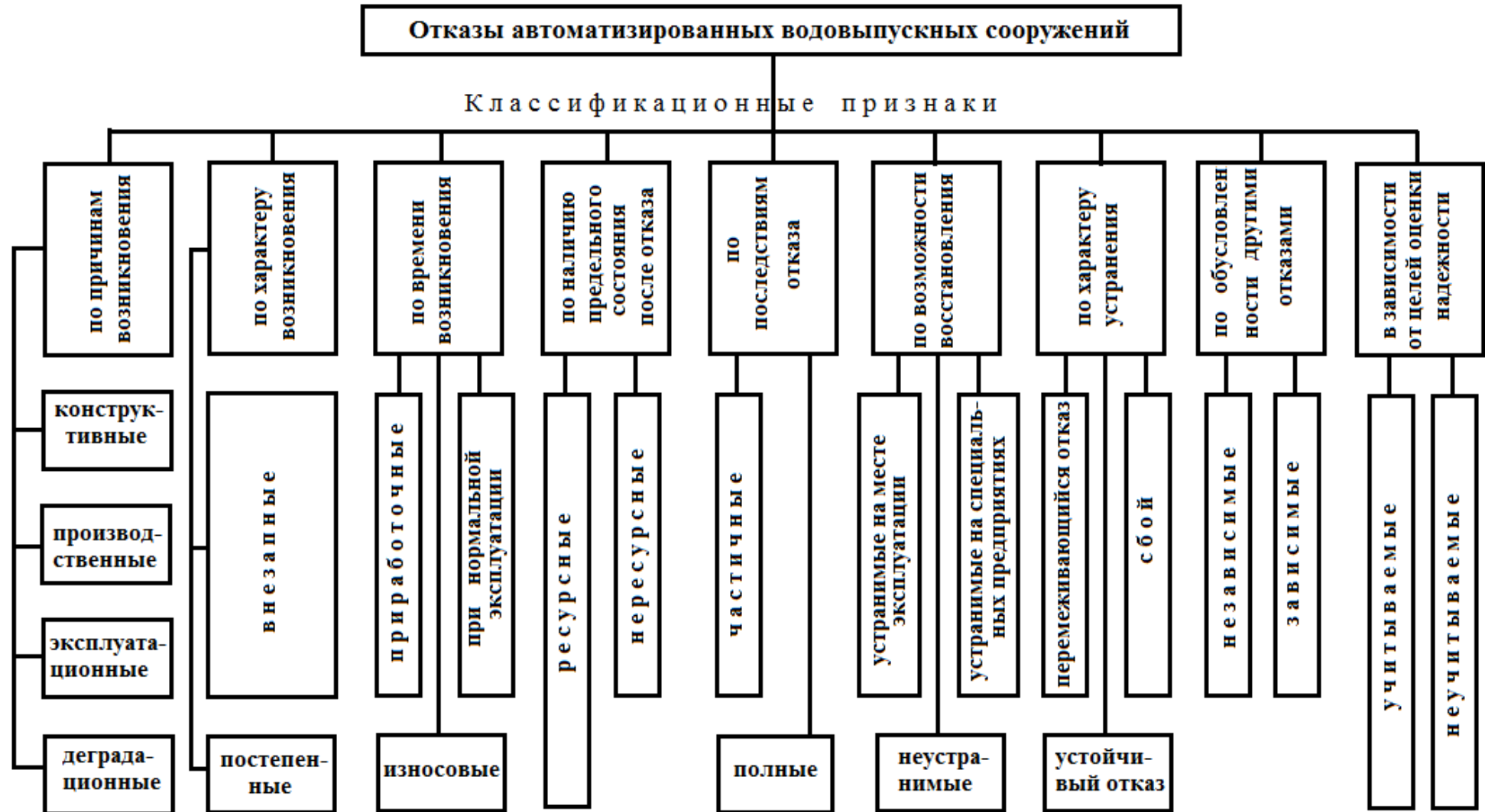
Рис. 2.2. Классификация отказов автоматизированных водовыпускных сооружений.
