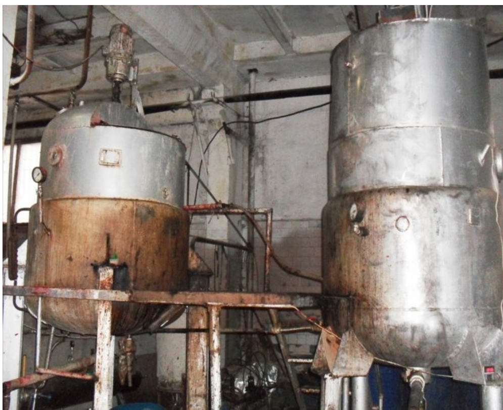
Рис. 1. Комбинированный бродильный аппарат: 1-цилиндрическая часть корпуса; 2- лопастная мешалка; 3-греющая рубашка
