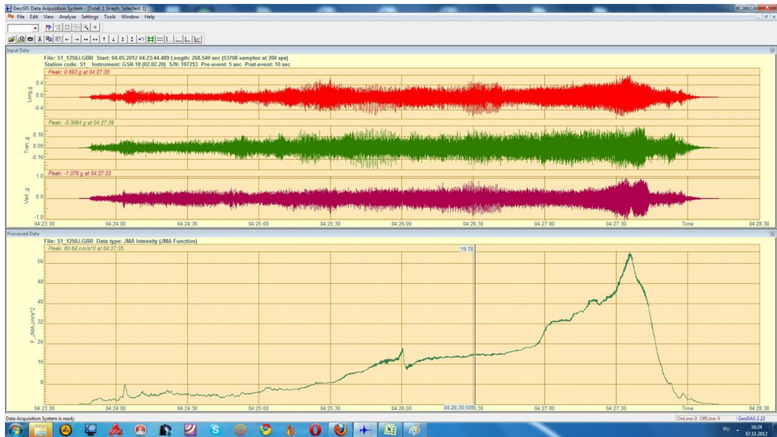
Рис.2.15. Запись интенсивности (балльности) колебаний виброплатформы на модели дома из «кирпича сырца», 4 мая 2012г. Ускорение - 20 \text{ см/с}^2
