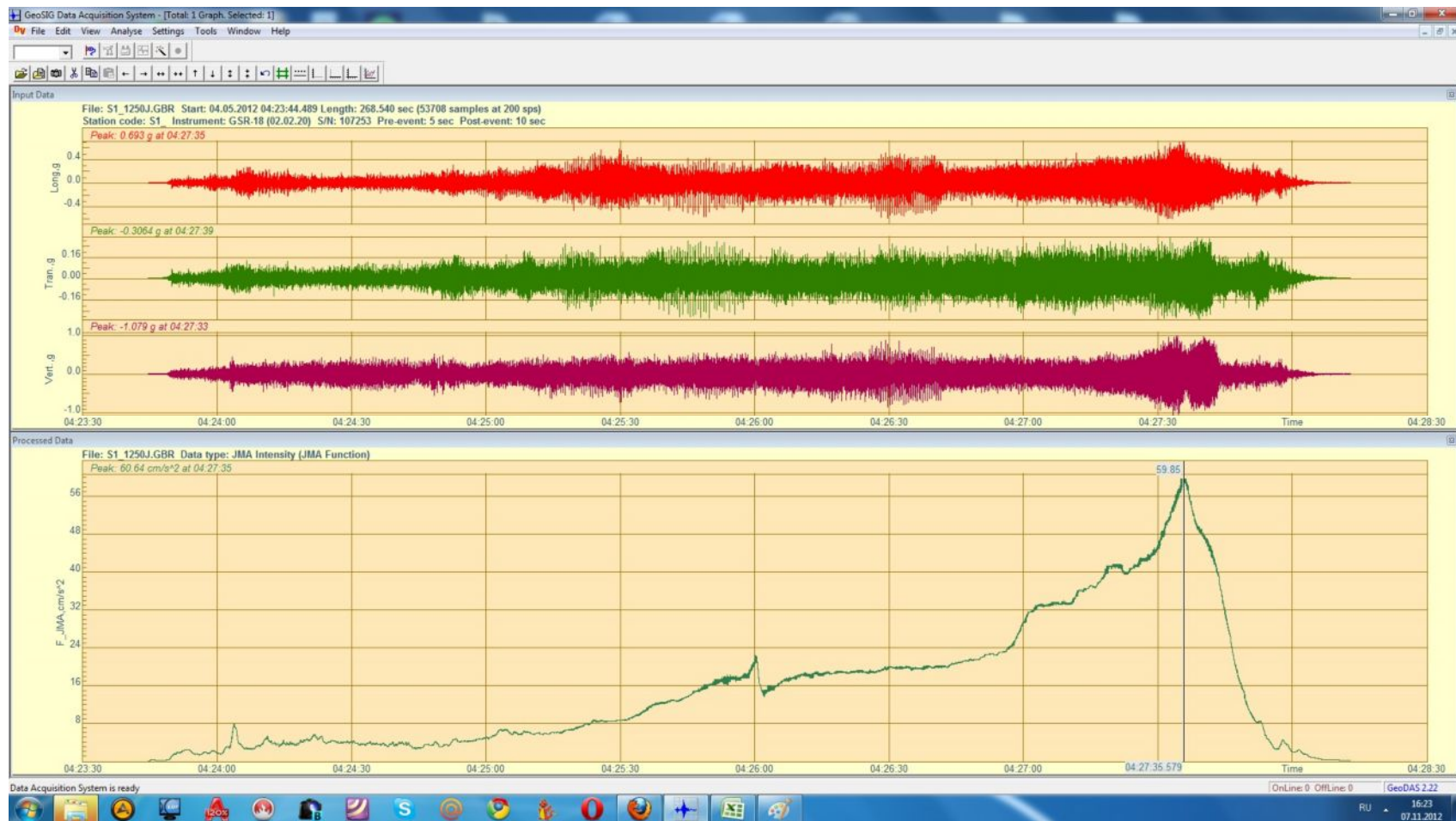
Рис.2.16. Запись интенсивности (балльности) колебаний виброплатформы на модели дома из «кирпича сырца», 4 мая 2012г. Ускорение - 60 \text{ см/с}^2
