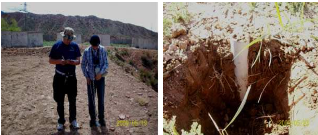
Рис. 4.22. Измерение экспозиционной дозы на территории хвостохранилища.
