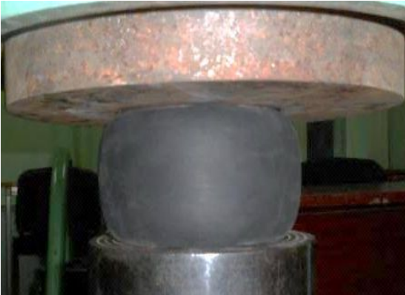
Рис. 1. Образец до испытания. Сжатие резинометаллического образца
