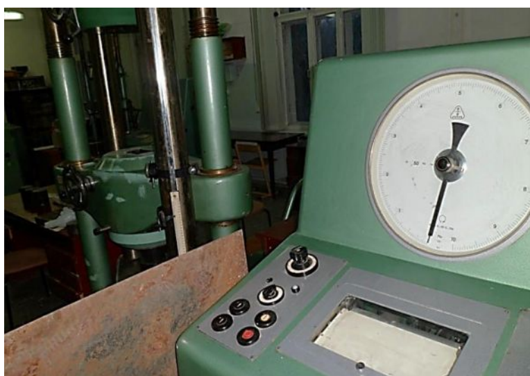
Рис. 2. РМА – вид сверху. Испытательная машина УМ-100
